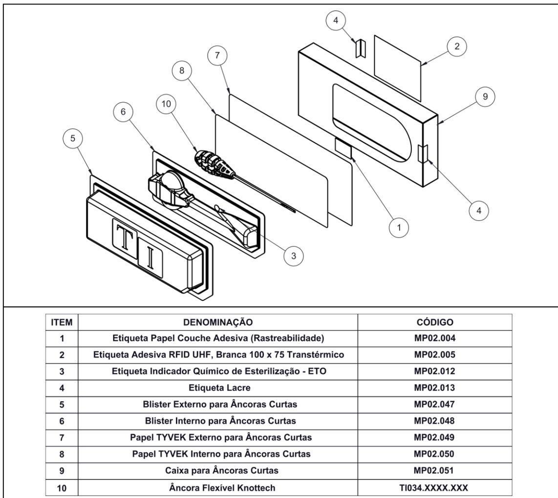
**Figura 4– Montagem da embalagem das Âncoras Flexíveis Knottech Techimport**
