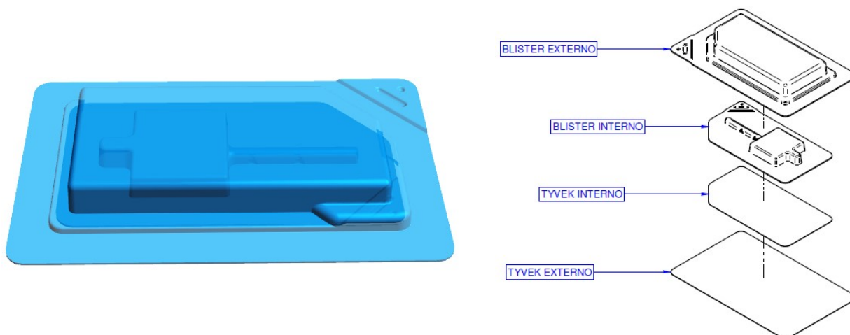
Figura 17– Representação do blister selado e sua ordem de montagem
